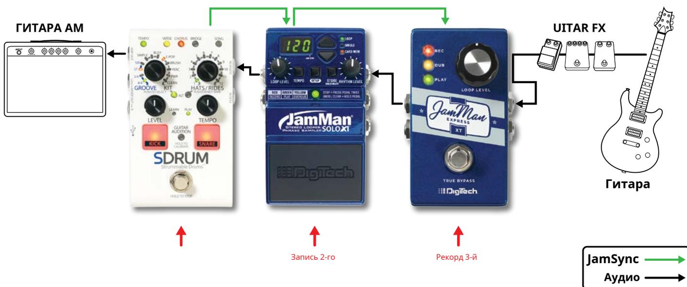
**ЗАМЕТКА:** При каскадной передаче звука через несколько последовательных циклов JamMan и использовании JamSync (как показано на диаграмме выше) SDRUM (хост) в большинстве случаев должен быть последним в цепочке. Затем вы захотите сначала обучить SDRUM, а затем записать на предпоследнее устройство и т. Д., Работая в обратном направлении по цепочке сигналов. Выполнение этих действий гарантирует, что вы будете записывать только то, что собираетесь делать во время каждого прохода.
