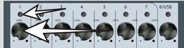
10. Настроить остальные каналы аналогичным способом. Для регулировки относительного уровня громкости каждого канала используйте ручки Уровня канала. Регулировку выполняйте до тех пор, пока не получите соответствующий баланс.
