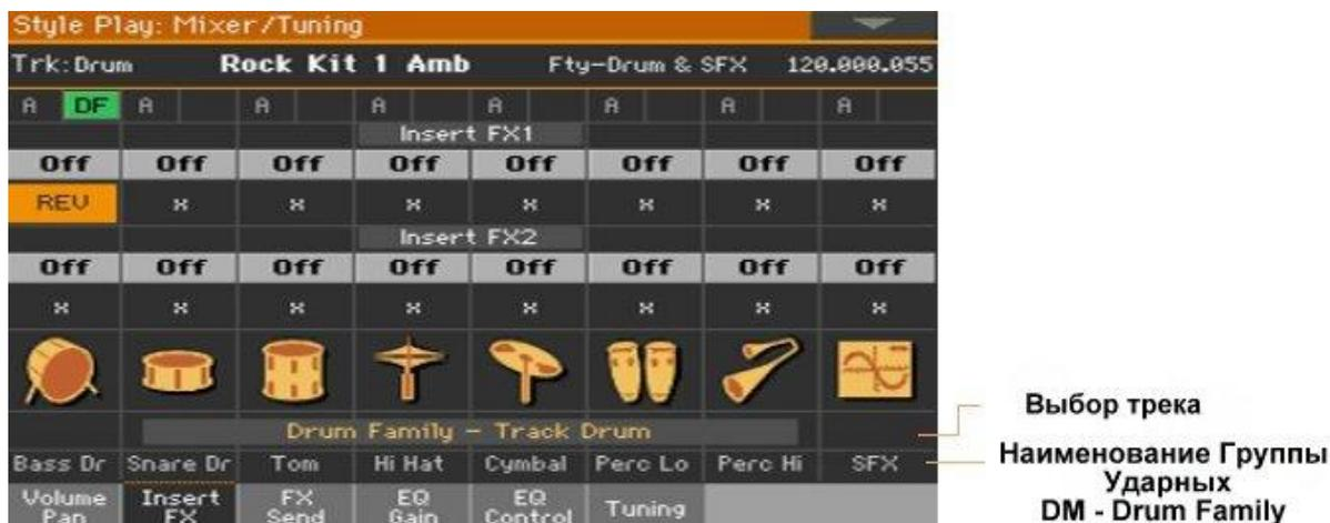
4. В каждой полоске Группы Ударных используйте различные регулировки для включения/выключения и выбора эффектов IFX.
