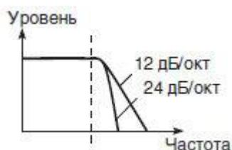
Фильтр ослабляет сигналы выше частоты среза. Это наиболее часто используемый фильтр, применяемый для "смягчения" тембра звука. Если для "Filter Type" выбрать опцию Low Pass Resonance, крутизна подавления увеличится.
