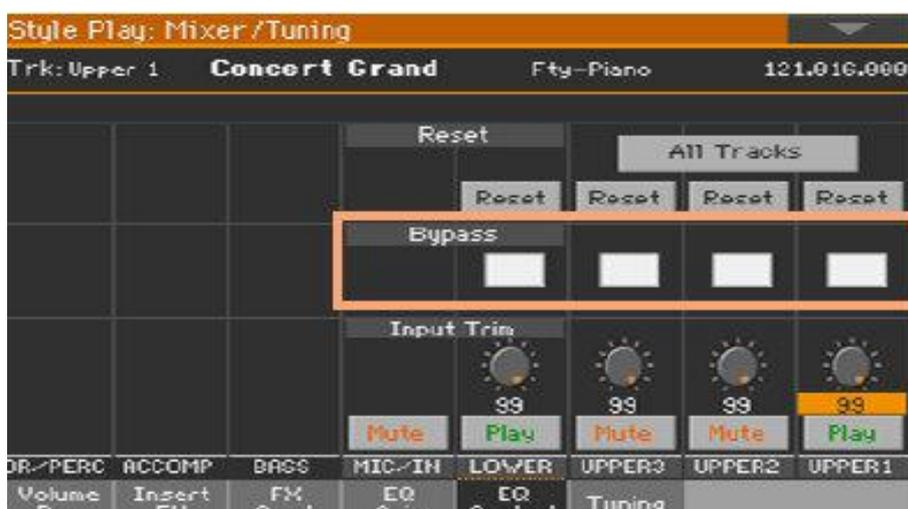
2. Поставьте или снимите метку с функции **Bypass** канала микшера, для включения или выключения EQ.
