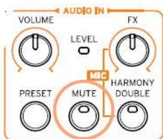
2. Отрегулируйте уровень громкости входного аудиосигнала с помощью ручки регулировки **VOLUME** в секции **AUDIO IN**. Проверьте уровень, наблюдая за уровнем индикатора LEVEL в том же разделе.
