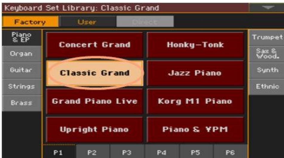
5. Если вы хотите закрыть окно **Keyboard Set Library** (в случае, если оно не закрывается автоматически), нажмите на кнопку **EXIT** на панели управления. Название выбранного Клавишного Набора будет отображаться в определенном месте Главной страницы. Звуки, присвоенные клавиатуре (отображенные в правой половине экрана), поменяются.
