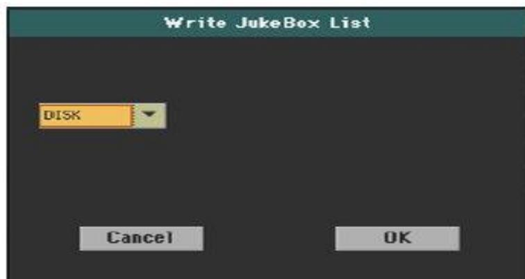
2. Используйте всплывающее меню Device, чтобы выбрать устройство для сохранения списка в виде файла TXT. Файл будет сохранен в корне устройства.
