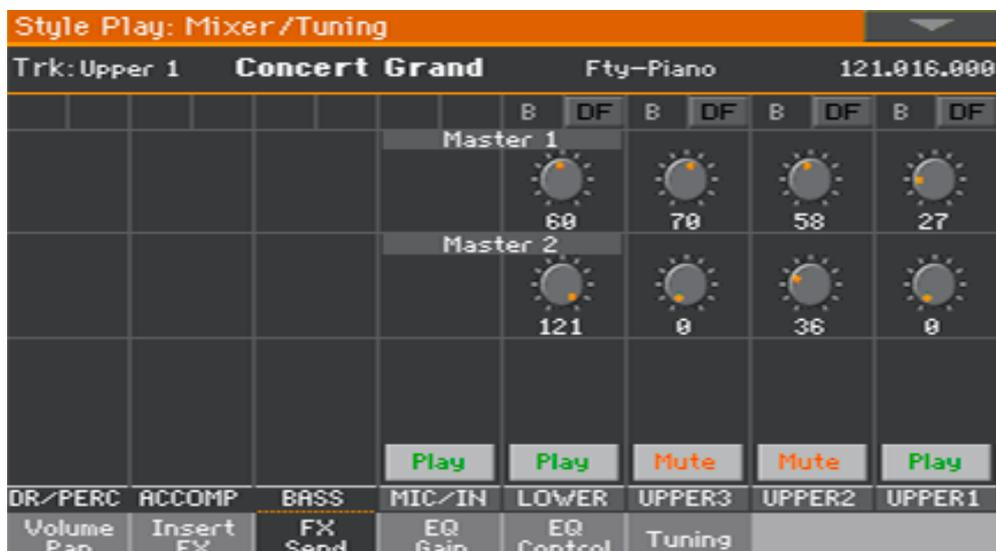
2. В каждом канале микшера используйте виртуальные ручки регулировки **Master**, для управления уровнем прямого (dry) сигнала, идущим на соответствующий FX процессор (внутри выбранной группы эффектов FX)
