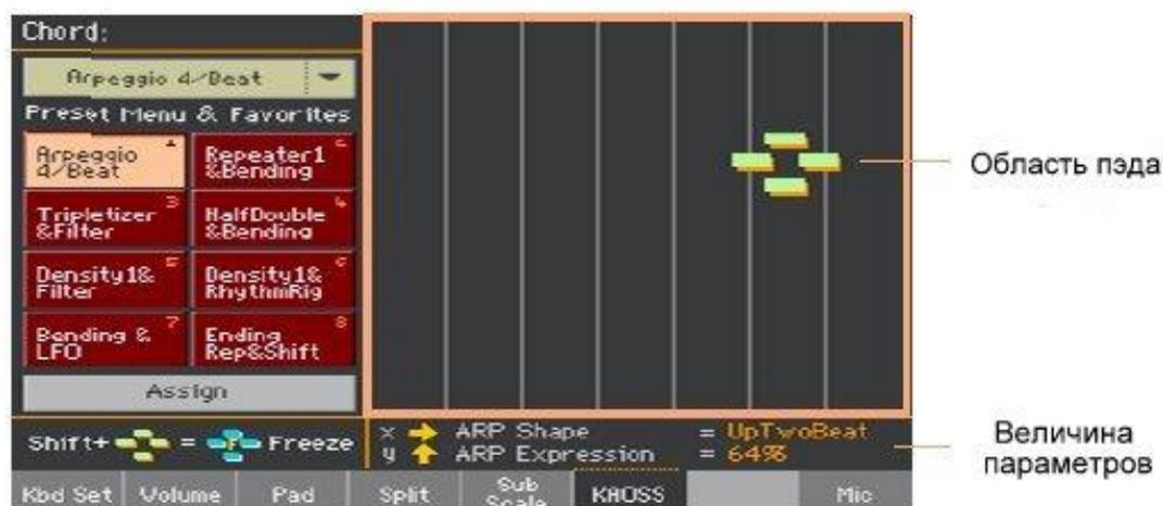
В зависимости от выбранного пресета, сетка на пэде KAOSS будет меняться. Каждая ячейка соответствует блоку значений (также называемым "шагом"). Светло-серые ячейки являются значением по умолчанию для соответствующего параметра.
